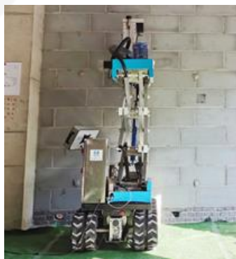
图 5.22 墙面开槽机器人
